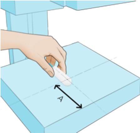
MAM センサーは、設定を変更せずにすべてのアノード/フィルタの組合せでの線量と HVL を測定することができます。センサーは、検査テーブル前端から 6cm（米国は 4cm）の十字線の中心部にセンサー上面の十字線が位置するように置きます。水平面角度が測定結果にもたらす影響は微少です。
