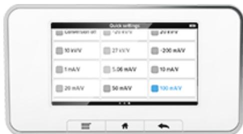
電圧 (V) と照射時間 (秒) 以外の測定パラメータも得たい場合は、該当する変換係数を選択してください。ホーム画面から右にスワイプすると、変換係数のクイック設定にアクセスできます。
