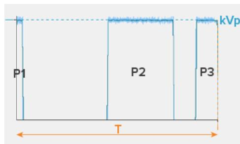
**T:** 照射時間**P1、P2、P3:** パルス**kVp:** 管電圧ピーク
