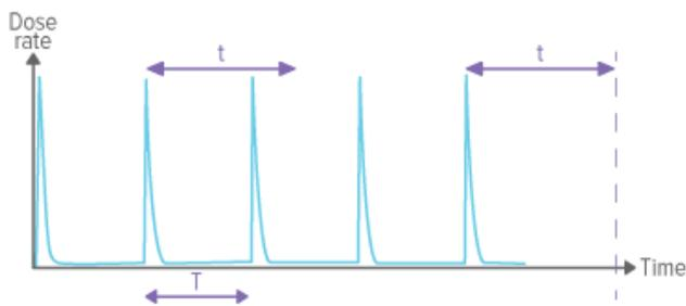
パルス間隔  $T$  よりもストップディレイ  $t$  を長くする ( $t > T$ ) と、パルス状の照射も一つの連続した測定となります。測定が終了して結果が表示されるまで、最後の照射の終了後にストップディレイ ( $t$ ) で設定した時間が経過するまで待たなければならないことにご留意ください。
