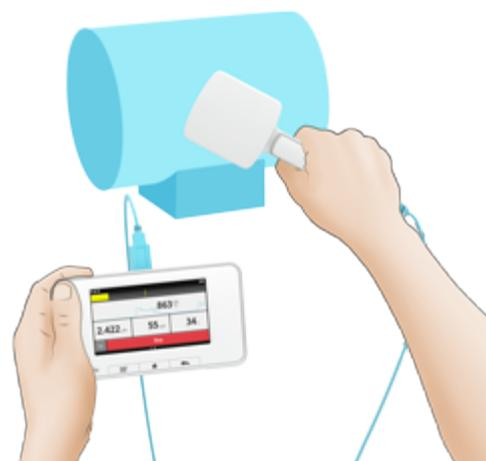
手動トリガモードでの測定では、測定を開始したいときには開始を、終了したいときには停止を押します。
