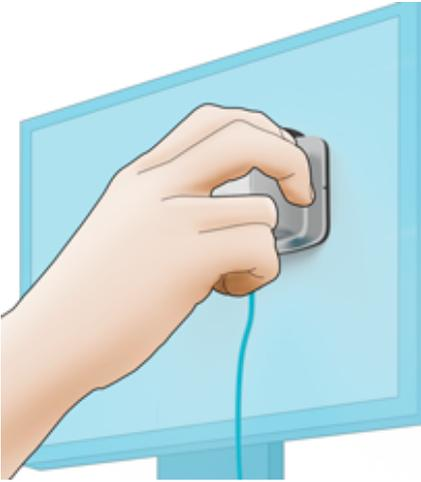
**輝度：**アパチャの付いた接続済みセンサーを測定したいエリアの中心に置き、センサホイールを輝度測定用のポジションに合わせます。
