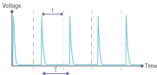
パルス間隔よりもストップディレイを短くする ( $t < T$ ) と、多数の短時間照射として測定されます。(1パルスごとに1回)。
