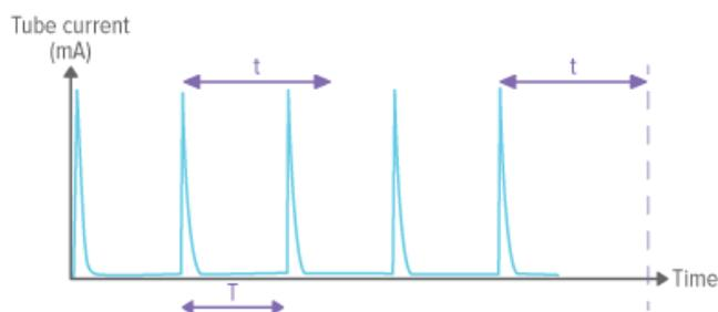
パルス間隔  $T$  よりもストップディレイ  $t$  を長くする ( $t > T$ ) と、パルス状の照射も一つの連続した測定となります。測定が終了して結果が表示されるまで、最後の照射の終了後にストップディレイ ( $t$ ) で設定した時間が経過するまで待たなければならないことにご留意ください。
