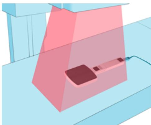
センサーは、黒い面を放射線源に向けて X 線照射野の中心に配置すると、低い線量率の測定にも使用できます。
