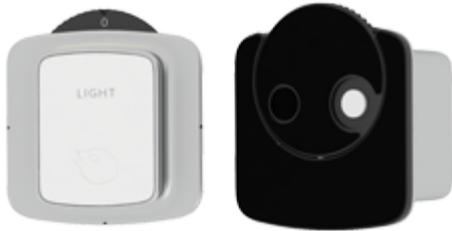
**ゼロ調整：**ゼロ調整を行うよう指示を受けたら、センサホイールでゼロ調整（0）を選択します。ゼロ調整には約10秒かかります。
