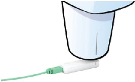
接続されたセンサーをX線照射野の中央部に、上面の十字線をX線管側に向けて置きます。四角いセンサー面全体が直接光線束内に入るようにしてください。
