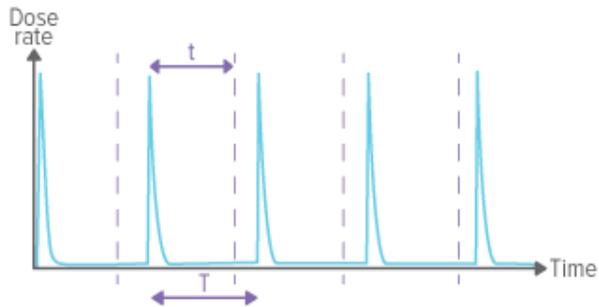
パルス間隔  $T$  よりもストップディレイ  $t$  を短くする ( $t < T$ ) と、各パルスが一回の照射として測定されます。
