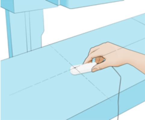
接続されたセンサーをX線照射野の中央部に、上面の十字線をX線管側に向けて置きます。水平面のセンサ角度は、測定結果影響をもたらしません。
