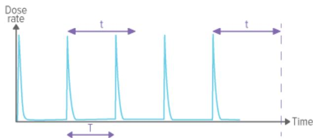
パルス間隔よりもストップディレイを長くする ( $t > T$ ) と、1回の長時間の照射として測定されます。測定が完了する前、最後の照射後のストップディレイ ( $t$ ) が終了し、数値が表示されるまで待たなければならないことにご留意ください。
