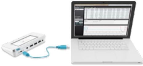
RaySafe View が動作しているコンピュータにベースユニットを接続して、コンピュータがインターネットに接続されていることを確認します。アップデートを利用できる場合、X2 Online フィールドに通知シンボルが表示されます。シンボルをクリックして、指示に従いソフトウェアをアップグレードします。
