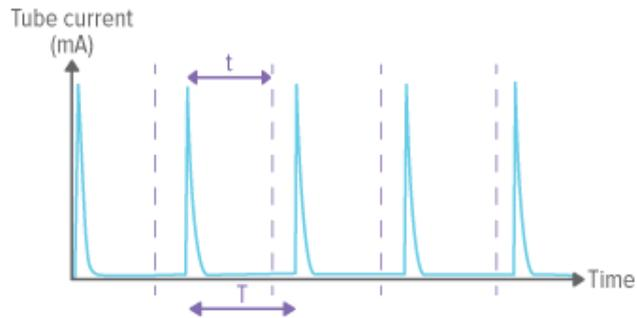
パルス間隔  $T$  よりもストップディレイ  $t$  を短くする ( $t < T$ ) と、各パルスが一回の照射として測定されます。
