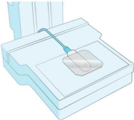
テーブルの左右方向の中心で、胸壁端から 6cm の位置にセンサーを設置します。センサーの上に 2mm の Al フィルタを置きます。センサー領域に X 線が照射されるようにします。
