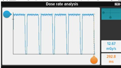
ハンドルをスライドさせて、パルスのピーク線量率などを表示します。2本の指を使って挟むように動かすと、波形エリアがズームインします。
