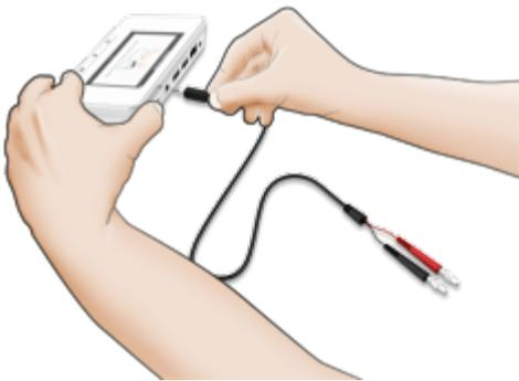
mAs ケーブルをベースユニットと発生装置に接続します。
