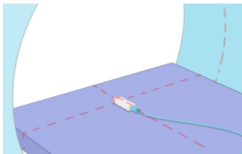
KVP測定については、R/Fセンサーを使用します。テーブルの上に平らに置き、回転せずに、スカウト、トモグラム、トポグラムモードで照射します。テーブルは動かさないか、動きを最小限にします。
