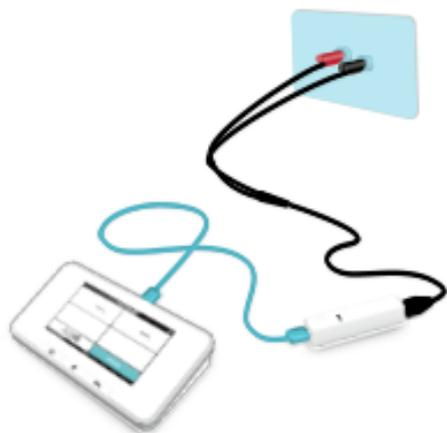
Volt ケーブルを使用して、Volt センサーを測定器に接続します。
