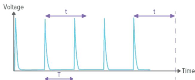
パルス間隔よりもストップディレイを長くする ( $t > T$ ) と、1回の長時間の照射として測定されます。測定が完了する前、最後の照射後のストップディレイ ( $t$ ) が終了し最後の照射後に数値が表示されるまで、ストップディレイで設定した時間 ( $t$ ) 待機しなければならないことにご留意ください。
