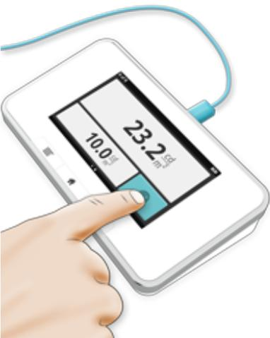
センサーは測定を継続します。数値を保存したい場合は、表示が安定したときにボタンを押します。保存された数値の下では、測定が継続されることにより表示は連続的に更新されます。
