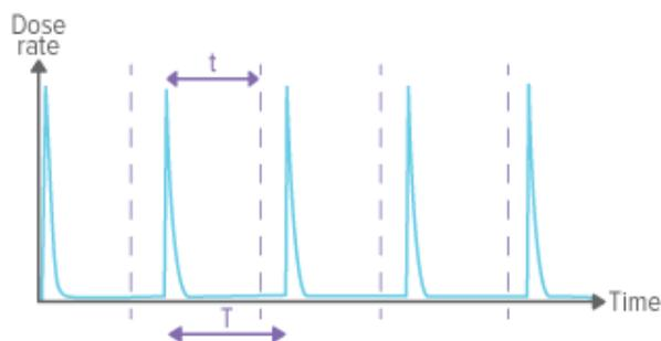
パルス間隔よりもストップディレイを短くする ( $t < T$ ) と、多数の短時間照射として測定されます。(1パルスごとに1回)。
