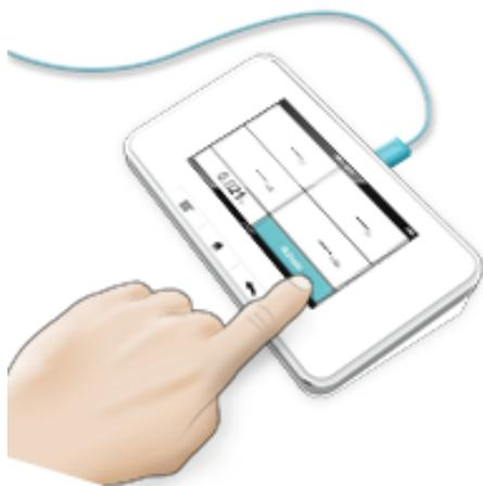
[有効化] を押して、測定器を測定可能な状態にします。
