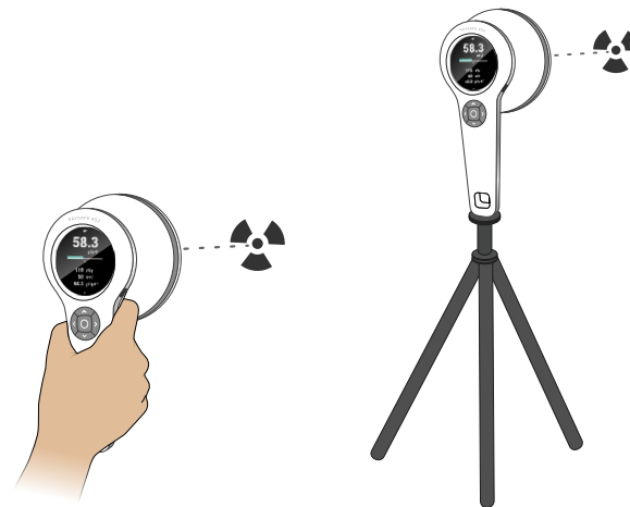
図3.センサーエリアが放射線源を向くように配置します。
