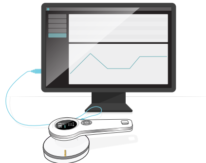
Abbildung 10. Das Gerät mit RaySafe View verbinden.
