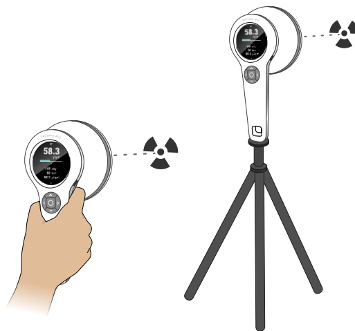
Figura 3. Posición con el área del sensor orientada a la fuente de radiación.
