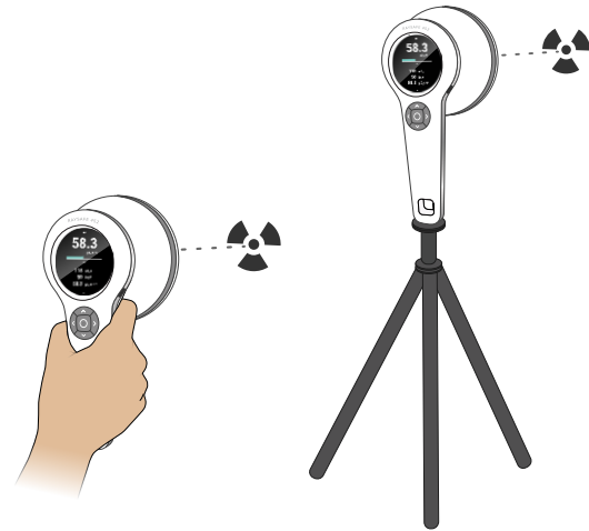
Figure 3. Positionner la zone du capteur face à la source de rayonnement.
