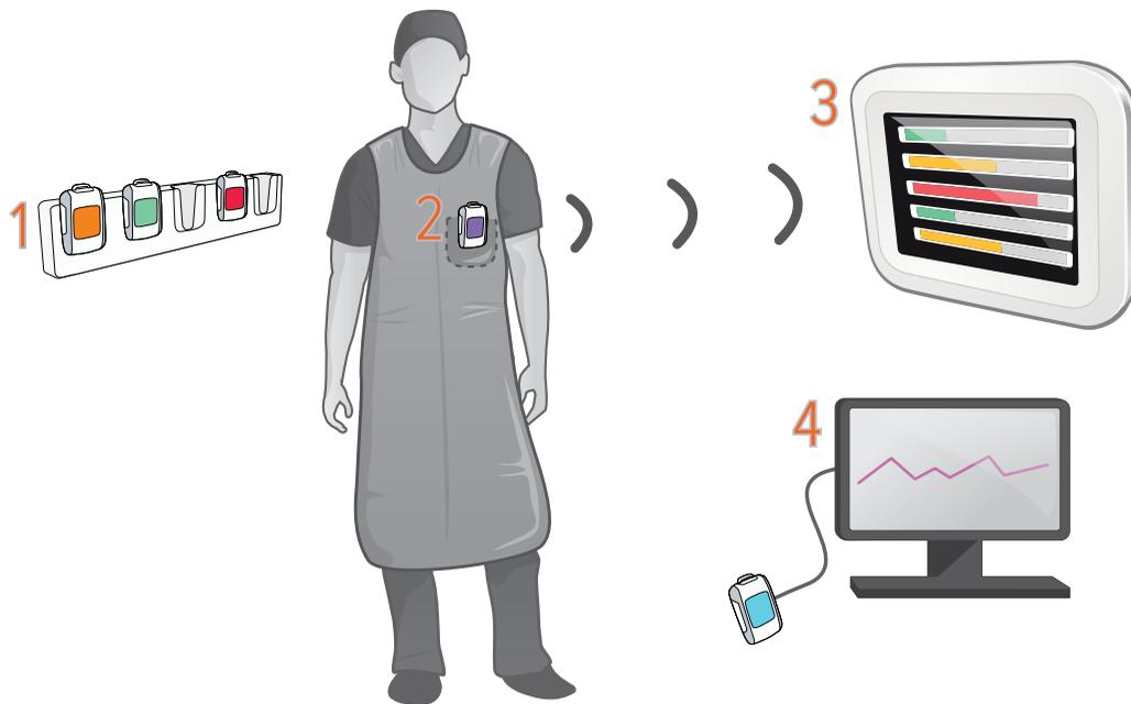
Figure 1. 1 : Rack pour dosimètre, 2 : Dosimètre en temps réel, 3 : Afficheur en temps réel, 4 : Logiciel Dose Viewer.
