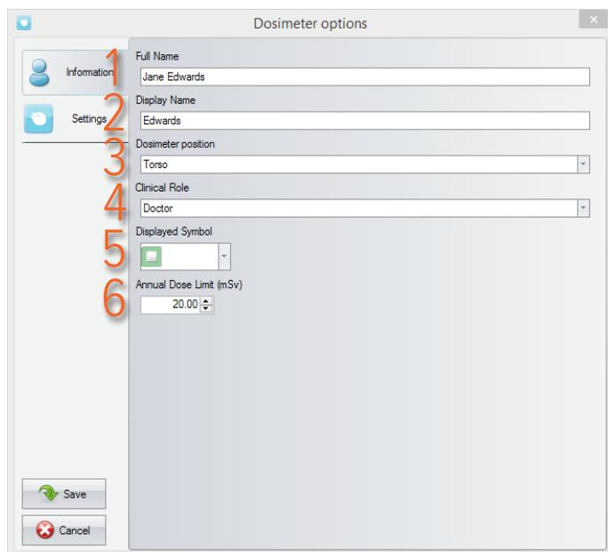
1. *Nom complet* : Visible dans le panneau d'informations du dosimètre dans Dose Viewer et dans la vue d'ensemble de la dose personnelle à laquelle vous accédez en tapant sur une ligne du dosimètre sur l'Afficheur en temps réel.
