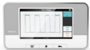
Appuyez sur un paramètre pour obtenir des chiffres de plus grande taille. Faites défiler l'écran sur la droite pour obtenir les informations sur les paramètres avec les spécifications concernant les mesures, et sur la gauche pour obtenir la forme d'onde, si elle est disponible pour le paramètre en cours.
