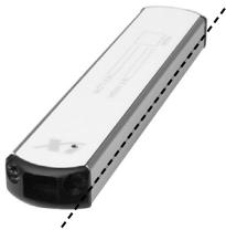
RaySafe Xi透過型検出器の場合、白い長方形がソリッドステートセンサーの位置を示します。ハウジング表面からの深さ方向の位置は、イラストのように長方形の長辺の位置で示されます。
