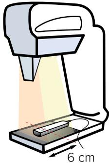
検出器をX線管軸に沿って置きます。この際、ケーブル側をマンモグラフィ装置側に向けます。MAMセンサーフィールドを示す四角形の中心がテーブル胸壁 端からの距離6cmとなるようにします。
