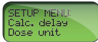
すべてのセットアップ値は不揮発性メモリに保存されると共に、マニュアルでの変更がない限り保存されている値が有効です。起動時(バッテリー情報が表示された後)には、有効なTrig delay (トリガディレイ)、kVp delay (kVpディレイ)、Calc delay (演算ディレイ)が順番に表示されます。
