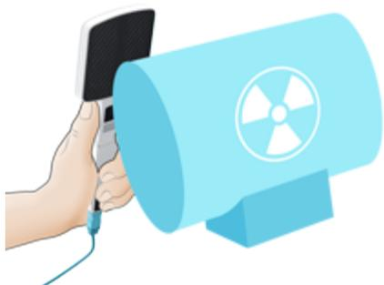
Coloque el sensor con el lateral oscuro hacia la fuente de radiación.
