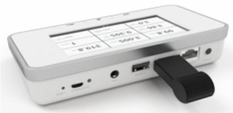
Conecte el adaptador Bluetooth a un puerto de SENSOR en la unidad base. Un símbolo de estado de Bluetooth en color gris aparece en la esquina superior derecha de la pantalla.
