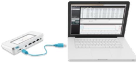
Conecte la unidad base a un ordenador que ejecute RaySafe View mediante un cable USB (longitud recomendada: 2 m como máximo).
