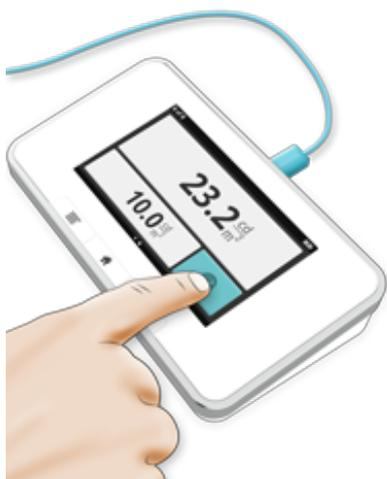
El sensor mide de manera constante. Si desea guardar un valor, pulse el botón una vez que se estabilice la lectura. La medición continuará por debajo del valor guardado.
