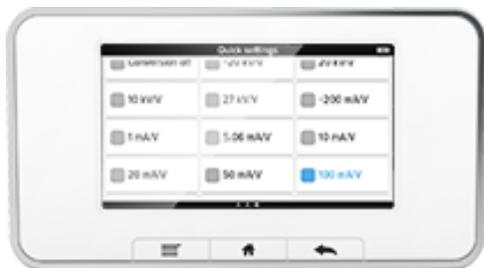
Para obtener otros parámetros de medición, además de la tensión (V) y el tiempo (s), seleccione un factor de conversión aplicable. Deslice el dedo hacia la derecha en la pantalla de inicio para acceder a la configuración rápida con los factores de conversión.
