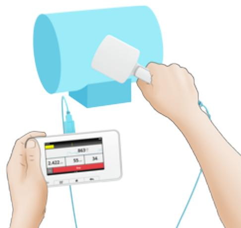
Si realiza la medición en el modo de activación manual, pulse *Iniciar* o *Detener* siempre que quiera empezar o terminar la medición.
