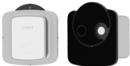
**Ajuste a cero:** Si aparece un mensaje solicitando que realice un ajuste a cero, seleccione ajuste a cero (0) en la rueda del sensor. El ajuste a cero tardará aproximadamente 10 s.
