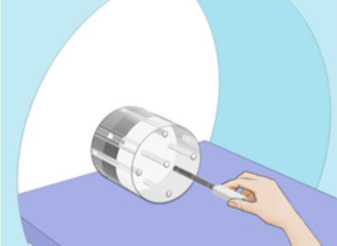
Presione el sensor conectado hasta ajustarlo en el maniquí...
