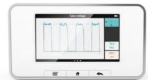
一つのパラメータ表示部をタップすると、そのパラメータの測定値が拡大表示されます。右にスワイプすると測定仕様を含むパラメータ情報が表示され、左にスワイプすると現在のパラメータの波形が (利用可能な場合) 表示されます。
