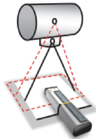
X線を照射しX線照射野のずれを表示で確認します。
