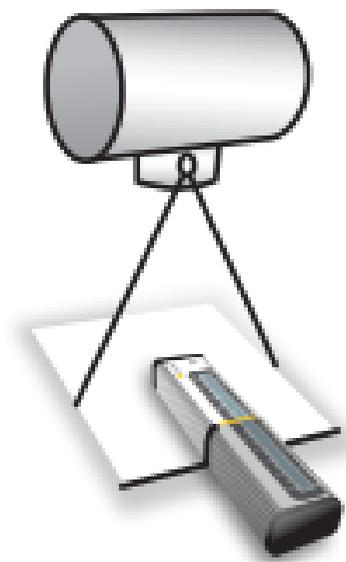
◀ X-ray マークがX線照射野側となるように置き、中央部の黄色い線を光照射野のエッジに合わせてみます。
