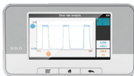
解析モード 波形を拡大表示して、パルスのピーク 線量率などを特定。
