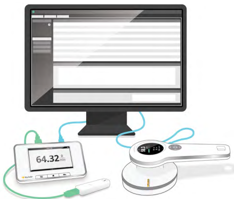
図 3. USBケーブルを使用して測定器を接続
