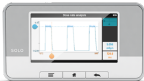
分析模式 放大波形以确定诸如某脉冲的峰值剂量率等参数。
