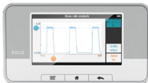
波形 kVp、線量率、またはmAの概要および簡易解析。
