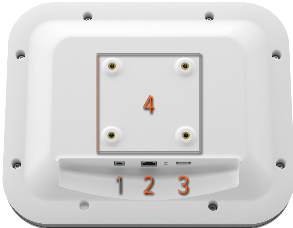
Figure 2. Les interfaces de l'afficheur en temps réel : 1 : 12 V CC, 2 : connexion Ethernet, 3 : Connexion USB, 4 : Interface VESA 75
